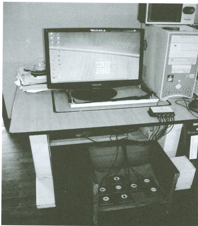
ภาพประกอบที่ 5: อุปกรณ์ทดแทนคีย์บอร์ดด้วยกลุ่มสวิตช์เดียวที่นำสวิตช์เดียวมาติดตั้งที่พื้นสำหรับเตรียมให้คนพิการที่ใช้เท้าในการกดสวิตช์แทนการใช้แขนและมือ
